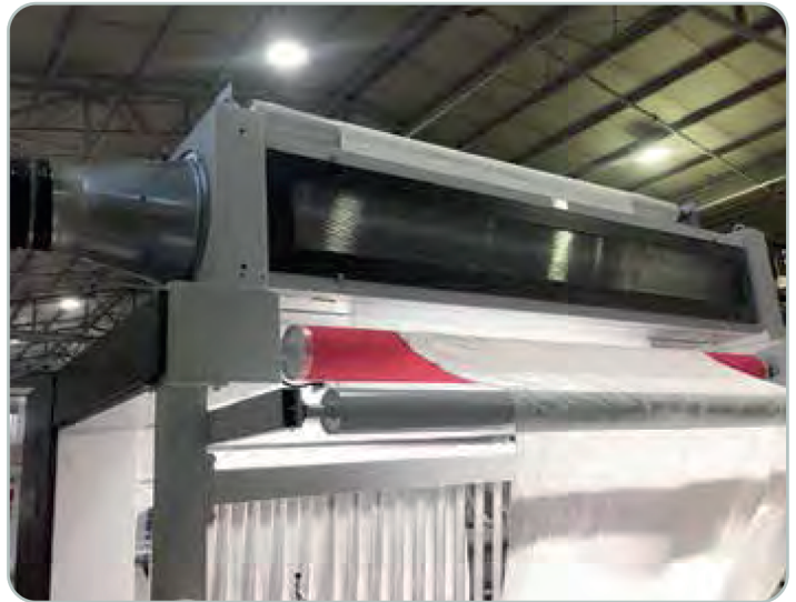
SPAZZOLATRICE PER PULIZIA TESSUTI CON UNITA' DI ASPIRAZIONE POLVERI
