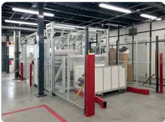
CARICO AUTOMATICO DEI ROTOLI IN INGRESSO LINEA
