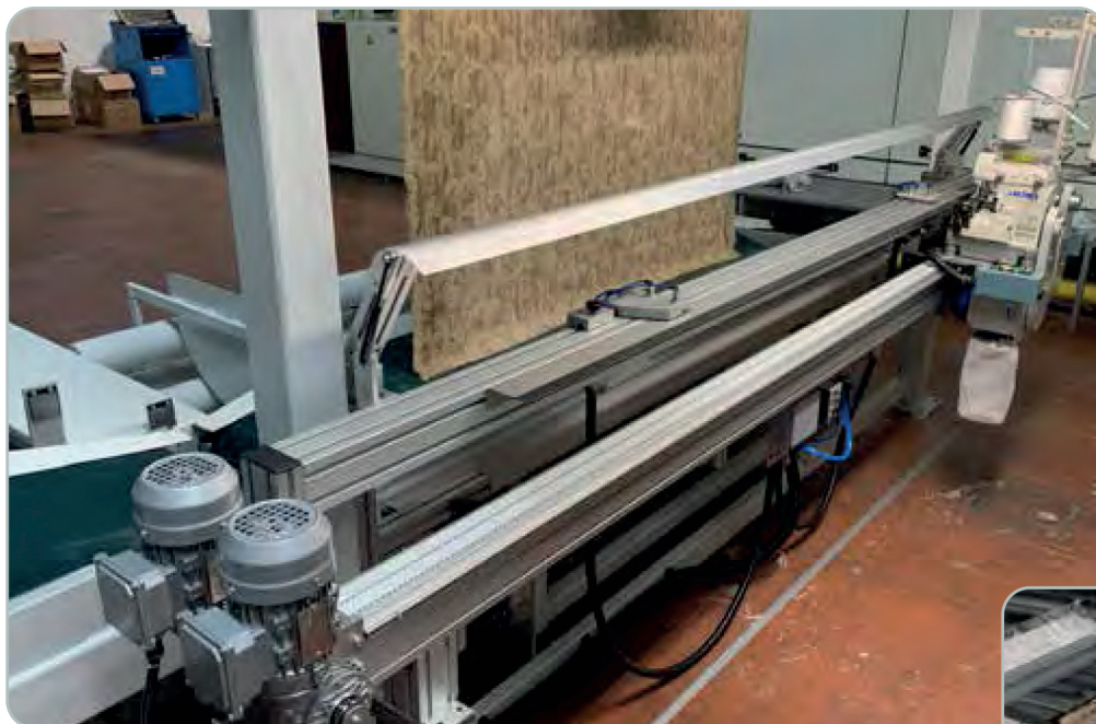
BINARIO DI CUCITURA AUTOMATICO PER LA GIUNZIONE LINEARE TESTA/CODA DEI TESSUTI
