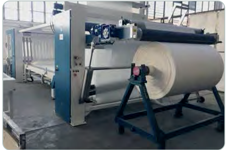
USCITA IN GRANDE ROTOLO CON ARROTOLATORE TANGENZIALE Tangential batcher to form big roll
