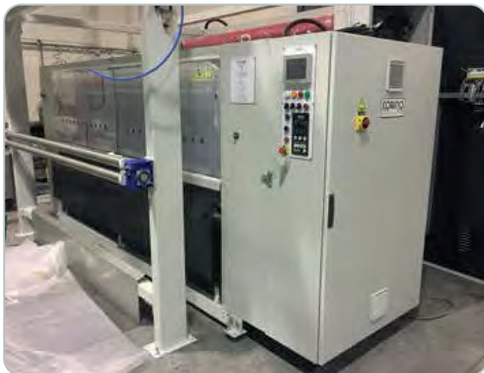
RADDRIZZATRICE A SPILLI INSTALLATO IN LINEA, PER OTTIMIZZARE LE OPERAZIONI DI PREPARAZIONE DEI TESSUTI A NAVETTA
