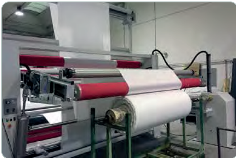
ARROTOLATORE COMBINATO ASSIALE/ TANGENZIALE UTILE ALL'AVVOLGIMENTO DI TESSUTI DELICATI. ALZATA AUTOMATICA DEL BRACCIO TANGENZIALE PER ARROTOLARE A DISTANZA SENZA CONTATTO SUL TESSUTO
