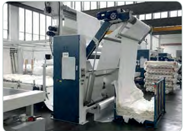
USCITA COMBINATA ARROTOLATORE/ FALDATORE Combinated exit folding/batcher
