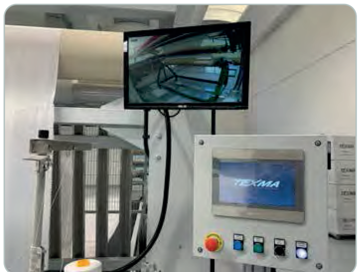
SOFTWARE PER INTERCONNESSIONE 4.0 E CAMERA DI VISUALIZZAZIONE USCITA MACCHINA
